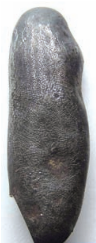
Kapljica na hitro ohlajene nikljevo- železove litine iz žlindre jeseniške železarne; 44 x 18 mm.
