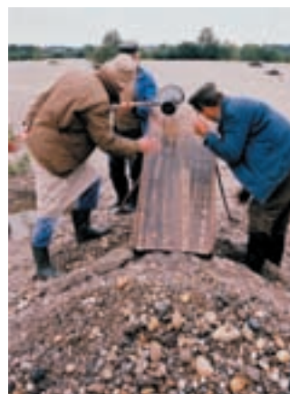
Na primernem prodišču so postavili topolovo desko in ločili drobnozrnati in težji material od debelozrnatega in lažjega. Foto: Milan Bidovec
